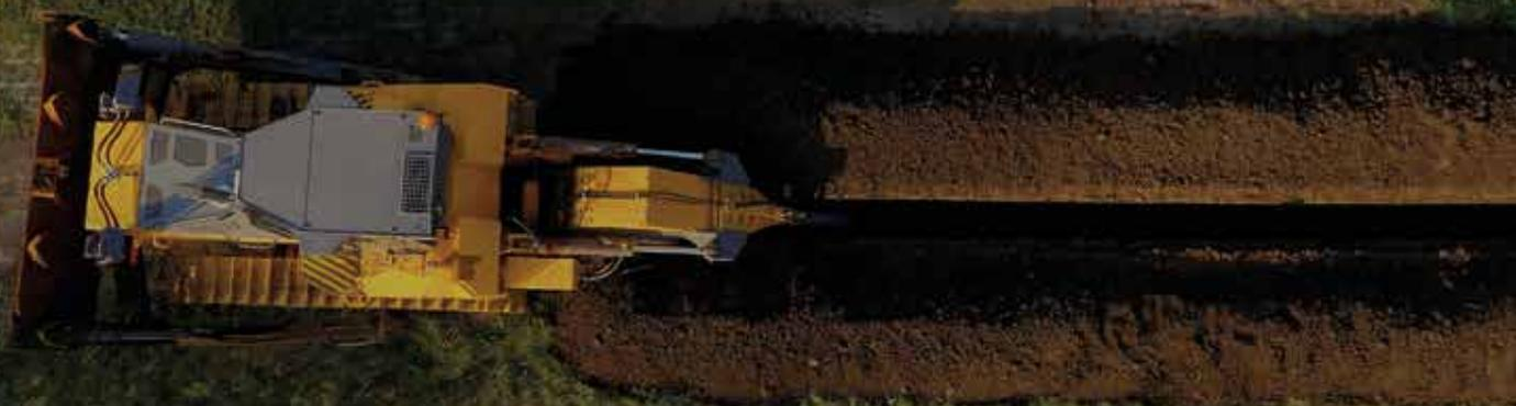
Бульдозер D25, оснащённый траншеекопателем применяется при земляных работах, используются для прорезания в грунте траншей или щелей, а также рыхления прочного или мёрзлого грунта в процессе его разработки.
